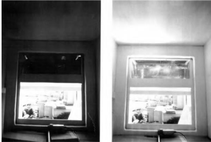
รูปที่ 13 เปรียบเทียบความส่องสว่างของห้อง ด้วยการบังแดดแบบเดิมกับและบังแดดที่นำทางแสงเข้าสู่อาคาร
